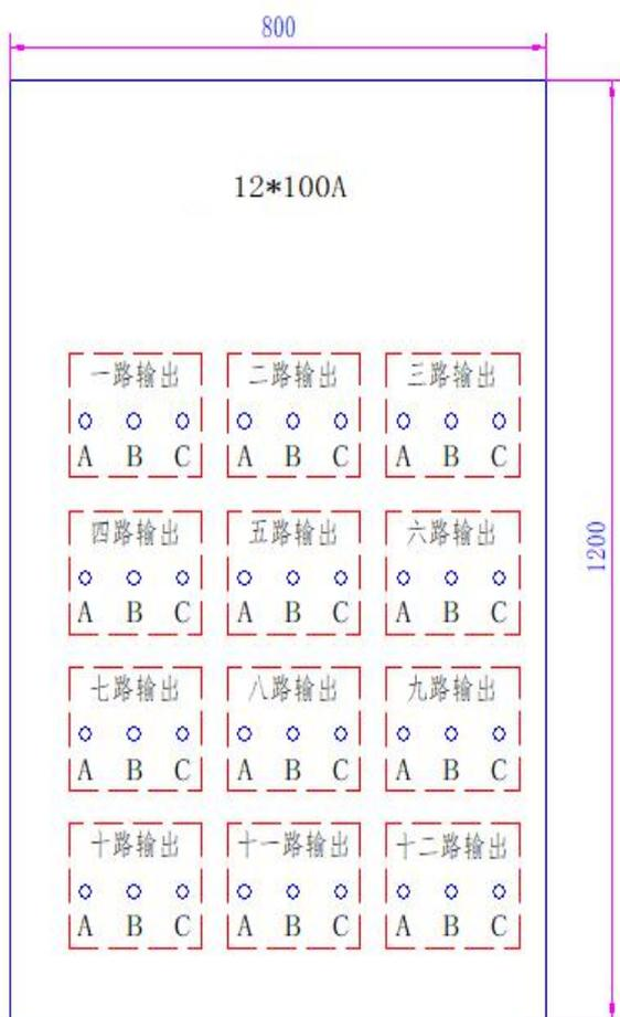
背部输出端子（直径 10 的快速接线端子）
