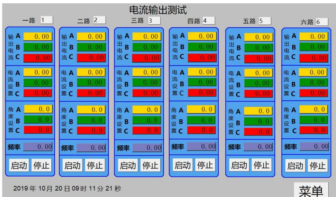
图中阿拉伯数字 1、2、3、4、5、6 为多路并联定义选择框, 输入相同数字的回路可并联到一起。
